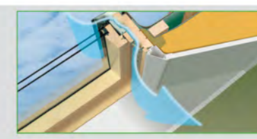
Тепла лабіринтоподібна вентиляційна щілина
